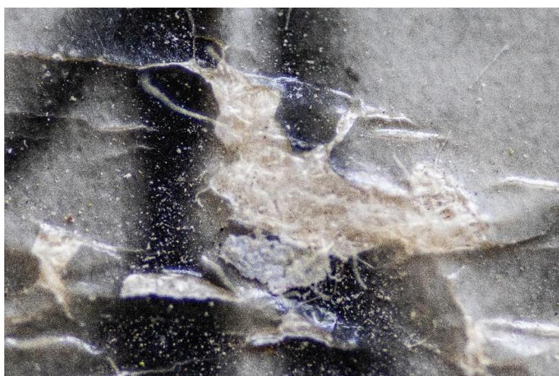
Figura 03. Macrofotografía del desgaste de una foto de archivo. Desprendimiento de material fotosensible
